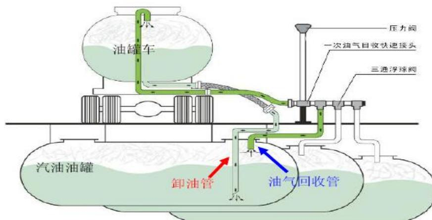
图 3 一次油气回收系统示意图
