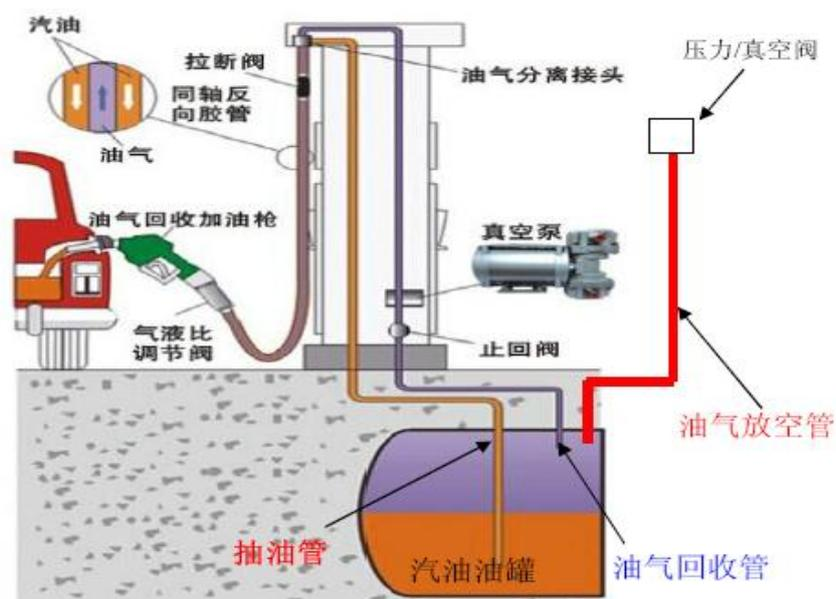
图 4 二次油气回收系统示意图
