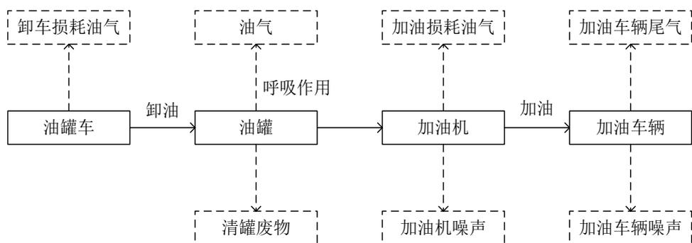
图 1 柴油加油工艺流程图及产污环节
