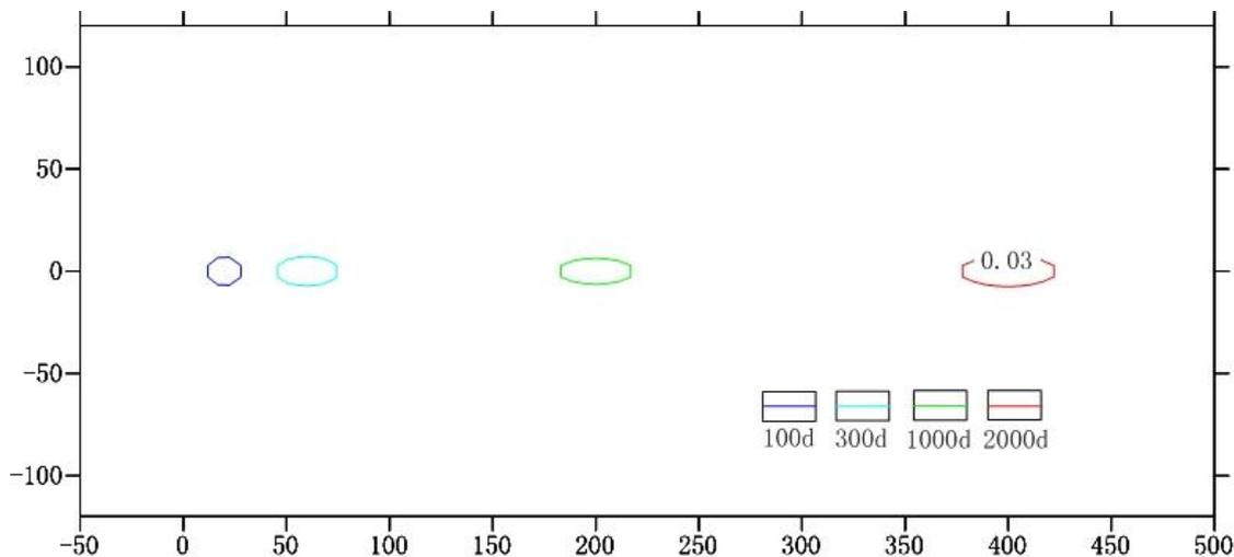
图 6 汽油储罐管道泄露污染物在浅层含水层中运移图
