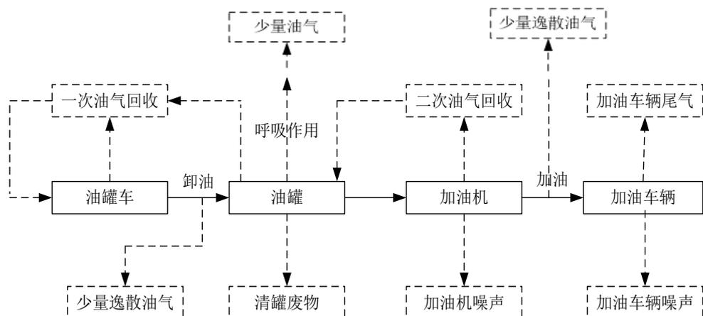
图 2 汽油加油工艺流程图及产污环节
